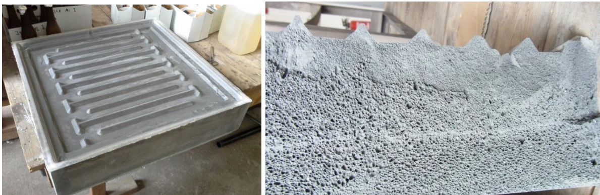
Abbildung 15: Schaumglas für Prototyp; links: Grundkörper; rechts: Schaumstruktur im Querschnitt
