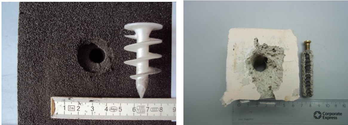
Abbildung 14: links: Dämmstoffdübel und zugehöriges Loch im Schaumglas vor der Zugprüfung; rechts: Gewindemuffe mit hinterlassenem Loch im Schaumglas nach der Zugprüfung
