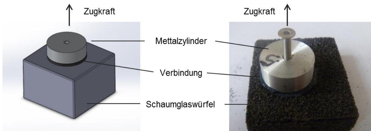
Abbildung 11: Anordnung zur Zugprüfung von Verbindungen
