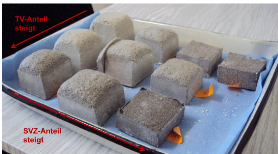
Abbildung 7: Überblick über Glasschäume aus variierenden Anteilen der drei Glasrohstoffe GR 2/ TV/ SVZ
