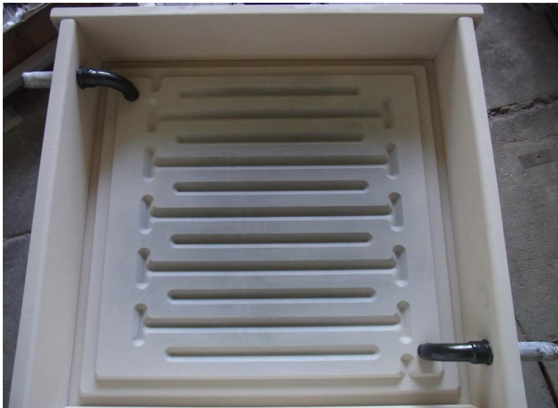
Abbildung 16: Form mit fixierten Rohrbögen (Blick von oben)
