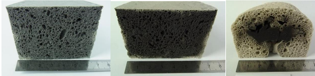
Abbildung 8: Schaumglasquerschnitte unter Verwendung unterschiedlicher Ruße als Blähmittel
