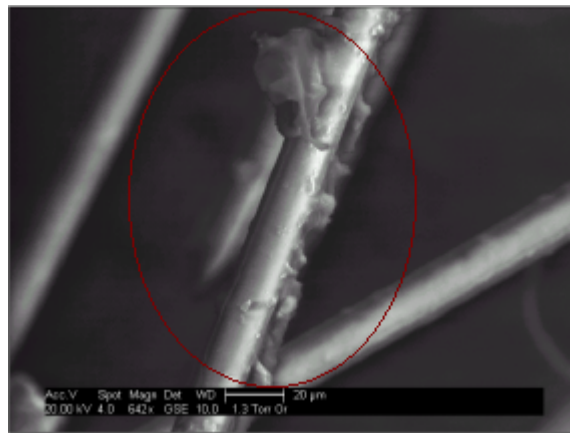
Figure 9 : Micrographie d'une décohésion fibre/ matrice dans un composite UD 45•
